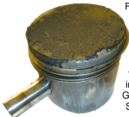
mehrere Kolben-Klemmer hinterließen ihre Spuren
