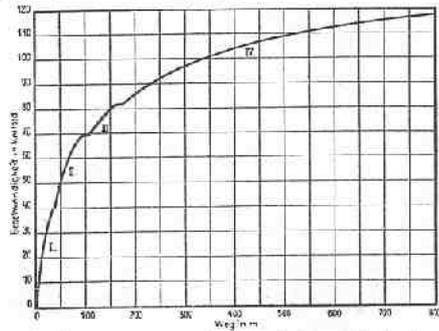
Noch überzeugender als die Spitzenleistung ist die glänzende Beschleunigung des Motors. Obwohl der 3. Gang nicht voll ausgenutzt ist, erreicht die Maschine 100 km/Std. schon 240 m nach dem Start. Man erkennt deutlich die sehr kurzen 5-Waltpausen, die nur mit der Fußschaltung möglich sind.
