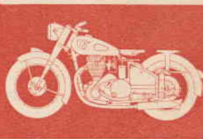
NSU-Konsul I und II 18 PS 110 km/h 3,5 Liter/100 km 22 PS ca. 120 km/h 3,6 Liter/ 100 km
